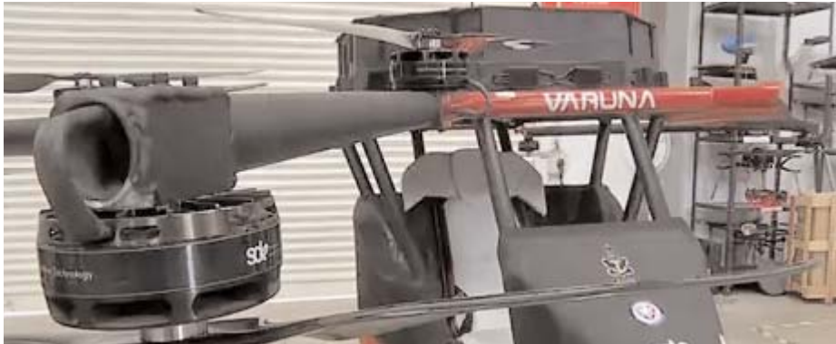
तकनीकी खराबी के बाद भी सुरक्षित लैंडिंग करने में सक्षम है। इसमें एक पैराशूट भी है, जो इमरजेंसी या खराबी के दौरान अपने आप खुल
